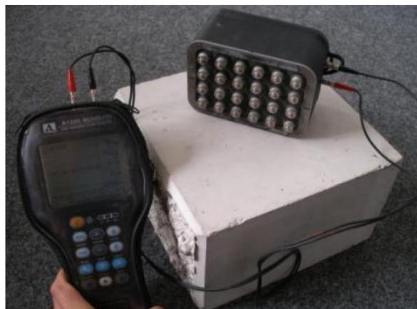
**Abbildung 1:** Ultraschallecho-Messgerät und Messkopf mit 24 Punktkontakt-Prüfköpfen.
